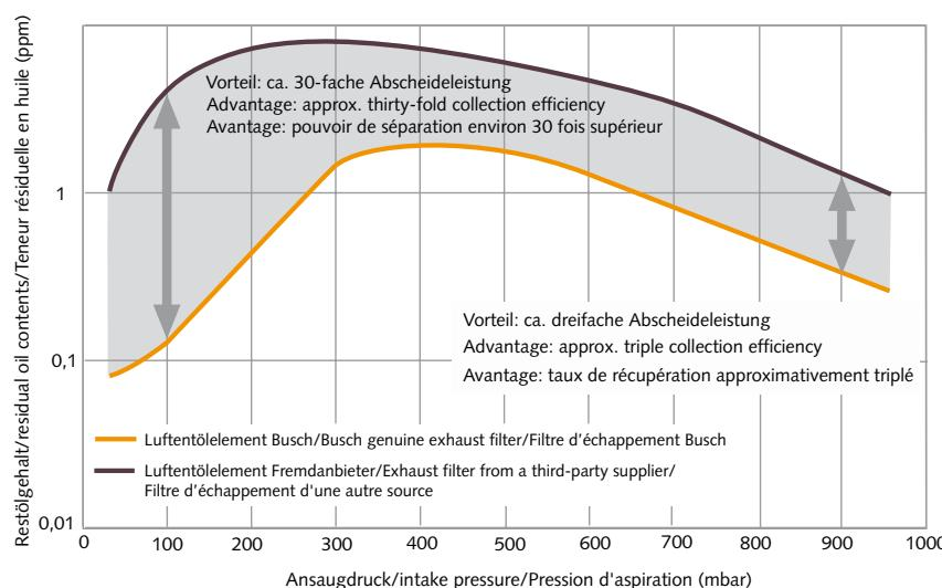
**Original Busch Luftentölelemente** sind hochwirksame Filtersysteme, die speziell zur Abscheidung des Ölnebelns aus der Abluft für ölgeschmierte Drehschieber-Vakuumpumpen entwickelt wurden. Busch Vakuumpumpen und original Busch Luftentölelemente bilden dadurch die ideale Kombination zur höchstmöglichen Ölabscheidung.
